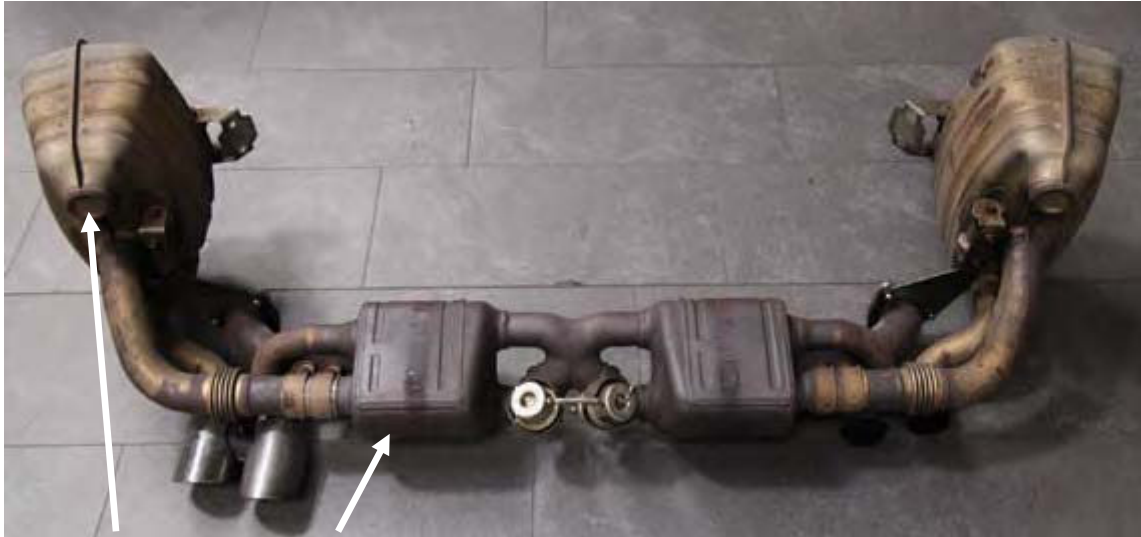
Serien-End- und Mittelschalldämpfer Series end- and rear silencer
